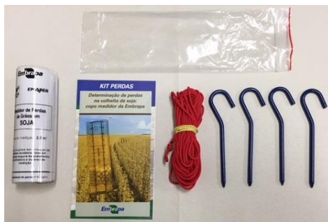
Figura 1. “Kit Perdas” da Embrapa Soja constituído por 1 Copo Medidor da Embrapa, 1 manual técnico, 1 armação em corda trançada de cor vermelha, 4 pinos de fixação, acondicionados em saquinho plástico.
